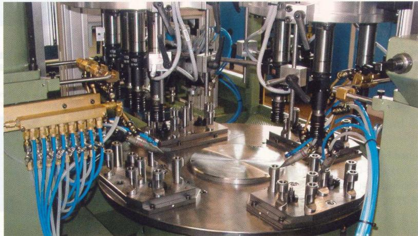
**4** Ansicht des Maschineninnenraums durch geöffnete Werkzeug-Wechseltür: Der Pfeiffer-Minimalmengen-Tropfendosierer verhindert Luftemissionen
