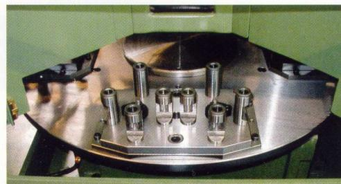
2 Die Beladestation ist durch Lichtgitter geschützt; Vorrichtungen zum Auflegen der Werkstücke, die nicht gespannt oder fixiert werden
