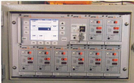
**3** Kontrollschrank des Artis-In-Prozess-Messsystems mit Visualisierungsmöglichkeit jeweils einer Bearbeitungskurve und Justierbarkeit der Akzeptanzbereiche. In Verbindung mit automatischem Entnahmesystem werden fehlerhafte Werkstücke direkt über eine Schublade beziehungsweise Rutsche ausgesondert
