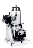
Der Wellenschraubstock LZ 7 ist ausgelegt für Maschinen mit horizontaler Hauptspindel. Er erleichtert das Arbeiten an wellenförmigen Werkstücken. Die Spannung erfolgt über Prismenspannbacken. Zum vorteilhaften Werkstückwechsel wird die obere Spannbacke seitwärts nach hinten geschwenkt, so das Werkstücke von oben eingelegt werden können. In Spannlage wird die Schwenkbacke mittels Handgriff arretiert.
