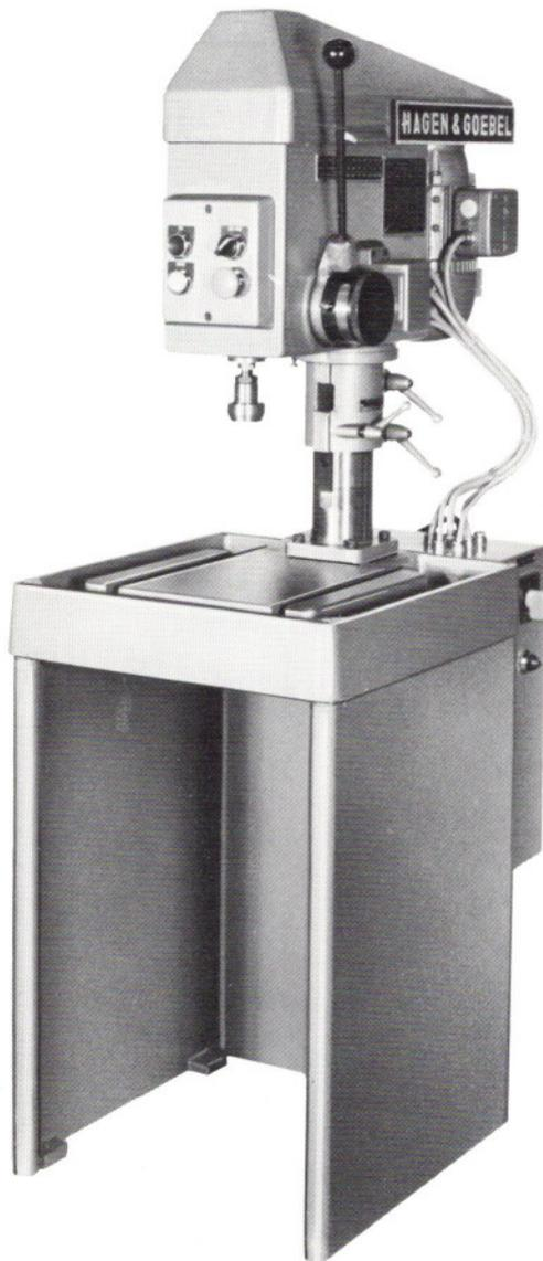
Die einwandfreie Funktion der Auflaufsicherung bei Leitpatronenvorschub ist auch bei Einsatz der kleinsten für die jeweilige Maschinentype noch zugelassenen Gewindebohrer gewährleistet.
