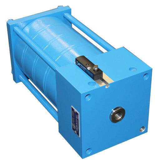
Durch Ausrüstung der H&G Multizylinder – Baureihe mit einem Positionstransmitter ist es nun möglich bei Hublängen bis zu 50mm die Position des Kolbens der Grundzelle direkt und berührungslos elektronisch zu erfassen.
