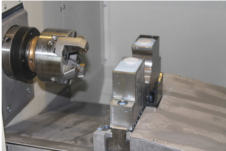
Bild zeigt: Zentrierspannstock in pneumatischer Ausführung mit umschließenden Backen und Endenbearbeitungswerkzeug
