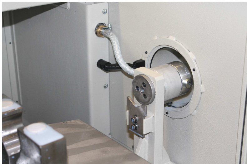
Bild zeigt: Hinterer Längenanschlag mit integrierter Vorablage und Kühlmittleinführung (Option)
