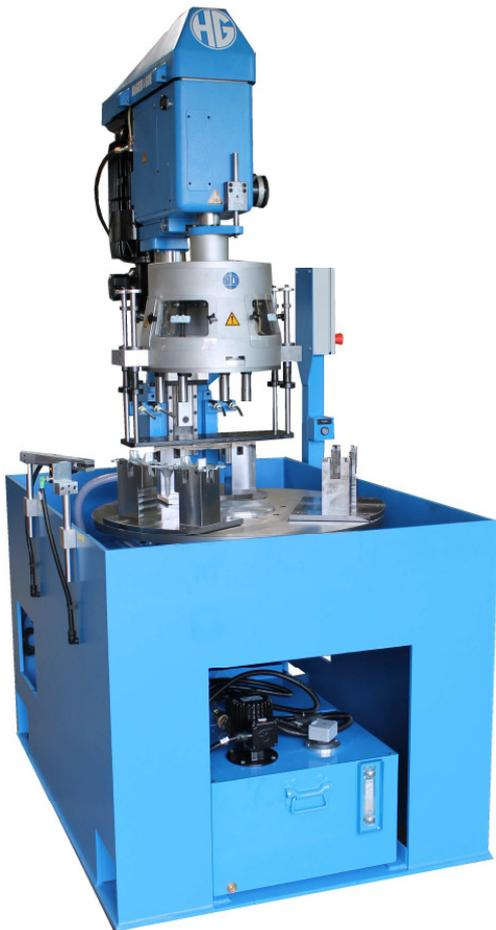
**4 Stationen Rundtaktanlage, Schlepptellerausführung mit HG-22 Servo und IN-PROZESS-MESSSYSTEM**
