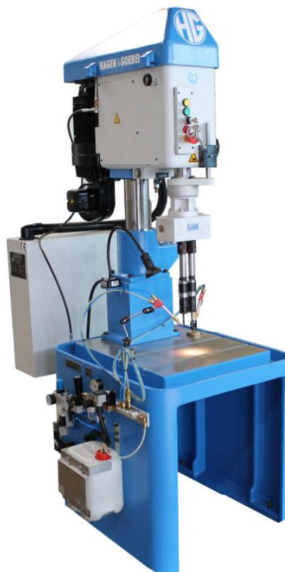
**Gewindemaschine HG-22E in Kastenständerausführung mit Mehrspindelkopf, und Minimalmengenschmiersystem (Sprühsystem)**
