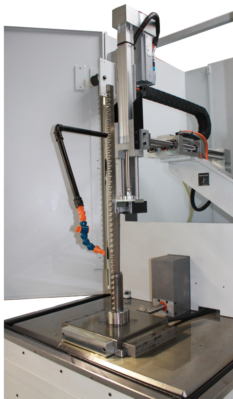
Räummaschine im Räumzyklus mit Werkstück, Räumnadel und aktivierter Keilzustellung
