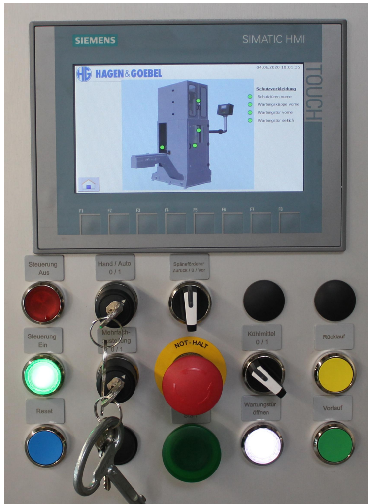
Bedienfeld mit Zustandsmeldung der Sicherheitseinrichtungen
