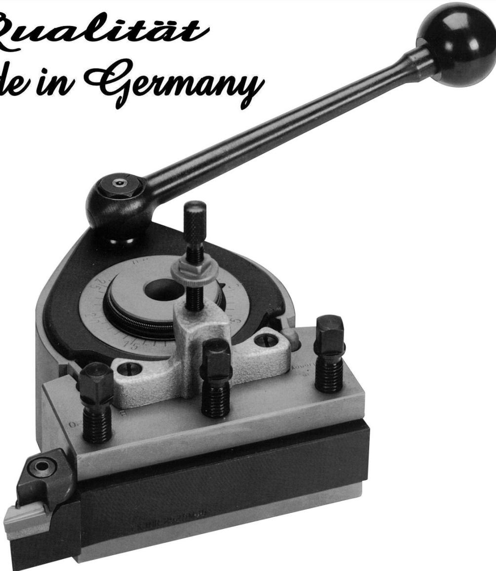
Der Trägerkopf und Stahlhalter sind mit einer gehärteten und geschliffenen Verzahnung versehen. Durch einen Excenterbolzen und ein Spannschalenpaar wird der Stahlhalter gegen die Verzahnung des Trägerkopfes gespannt. Dieses System ermöglicht eine Wiederholgenauigkeit von 0,01 mm bei 40 möglichen Winkeleinstellungen des Stahlhalters.
